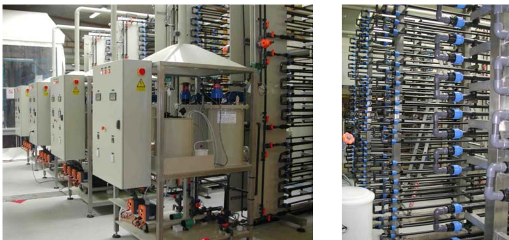
Figure 2 : banc de vieillissement accéléré : 40°C, 6 bar, pH 7.2, 1 ppm ClO 2 , 4 ppm HclO, 4 ppm NH 2 Cl
